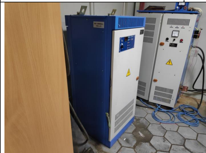
Испытательный стенд для проверки инверторов на основе IGBT-модулей в комплекте с нагрузкой
