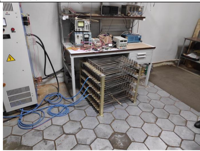
Испытательный стенд для проверки инверторов на основе IGBT-модулей в комплекте с нагрузкой
