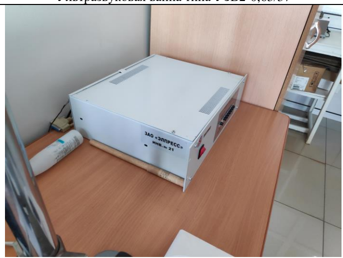
Система измерения удельного электрического сопротивления 4х-зондовым методом и времени жизни Н.Н.З.
