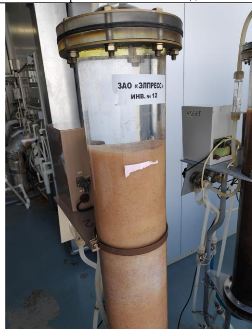
Установка финишной очистки воды УФ-400
