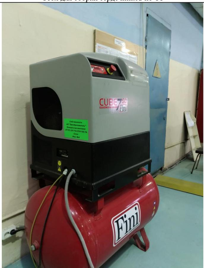
Компрессор винтовой стационарный ET-FC SD-710-270-F-ES-TA Cover
