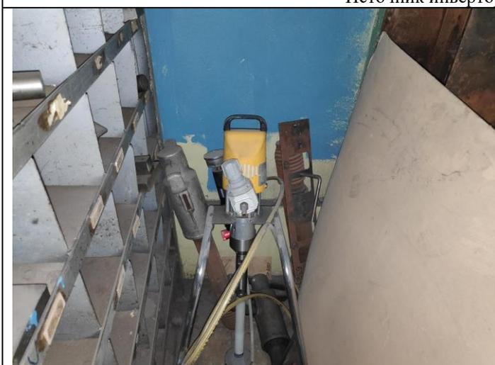
Окрасочный агрегат высокого давления (безвоздушного распыления) TAIVER 3200P
