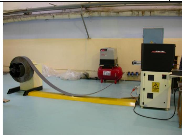
Станок для гибки и резки стали UCM 3000/12 с размотчиком UDM 4000/12
