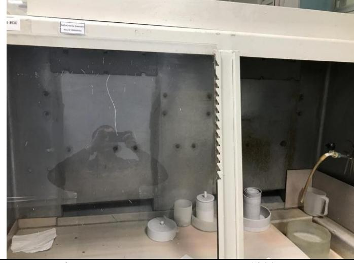
Шкаф вытяжной модульной с водой 1200ШВМнв
