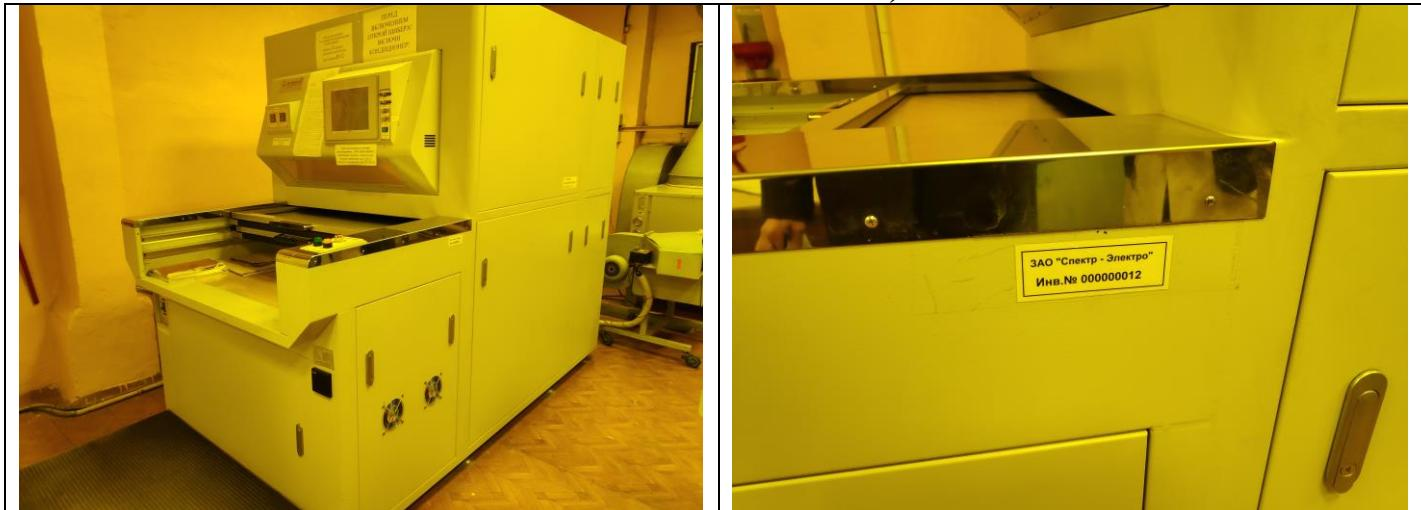
Установка экспонирования с оптимизированным источником света SMV-SME8K-PC5
