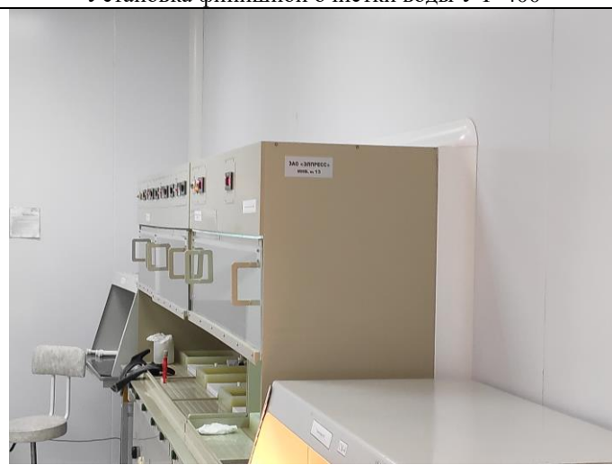
Установка очистки деталей перед сборкой
