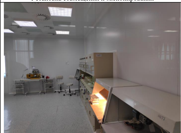
Установка очистки деталей перед сборкой
