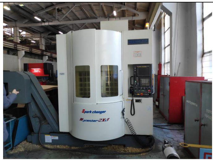
Вертикально-фрезерный обрабатывающий центр Kitamura с ЧПУ Kitamura-Fanuc 16iMB
