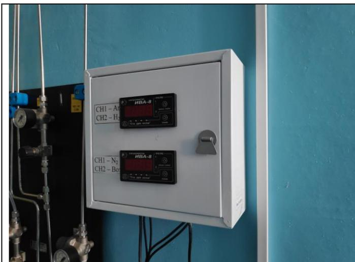
Система для измерения температуры точки росы сжатых газов
