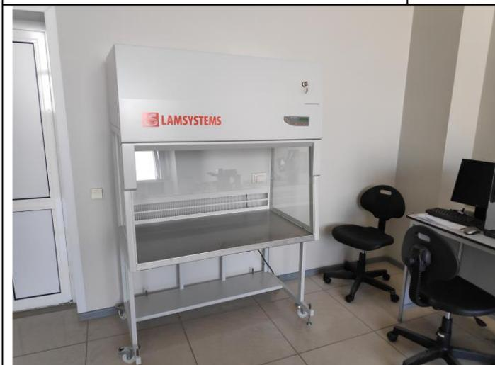
Шкаф вытяжной для муфельной печи ПГЛ-ВШМ1-1,2-2С,
