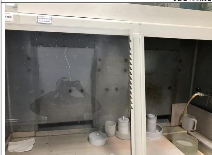
Шкаф вытяжной модульной с водой 1200ШВМнв
