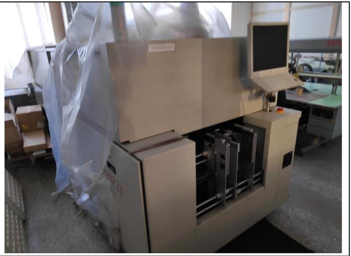
Конвейерная печь конвекционного оплавления
