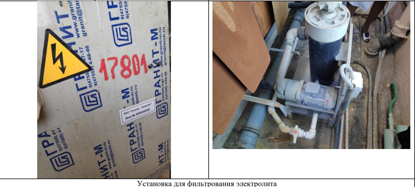
Установка для фильтрования электролита
