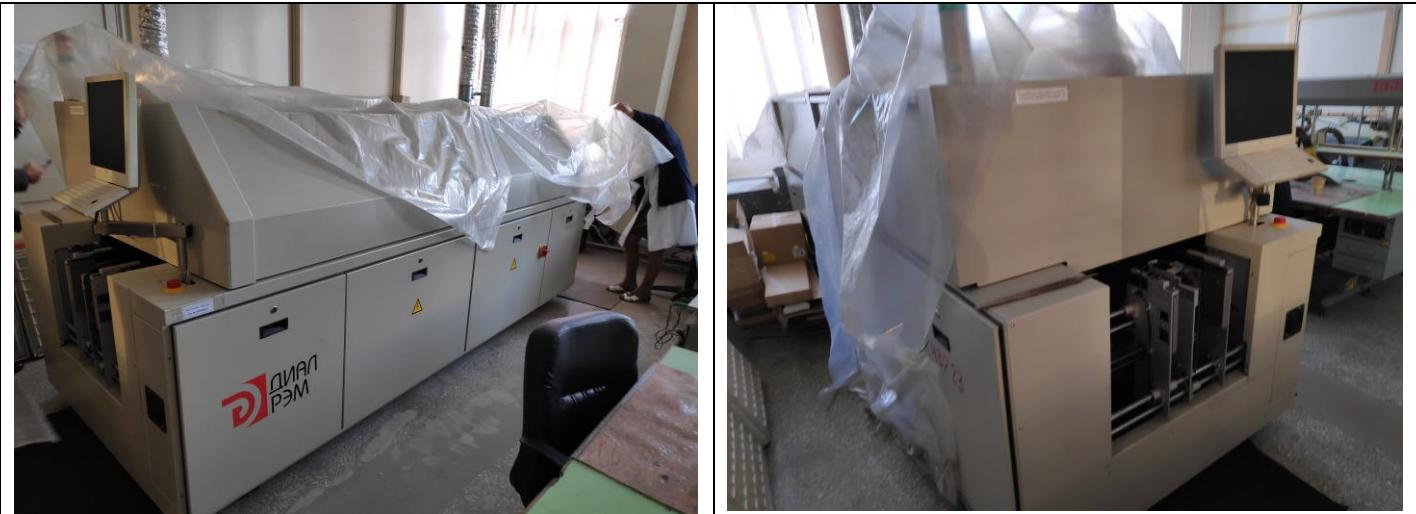
Конвейерная печь конвекционного оплавления
