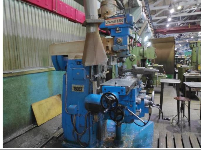
Широкоуниверсальный фрезерный станок UW-mill 1300
