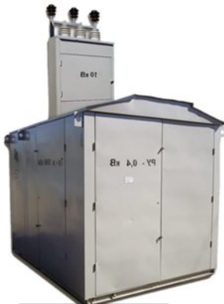
КТП-ВК-630-10/0,4-УХЛ1 представляют собой одно- и двухтрансформаторные подстанции тупикового и проходного типа, наружной установки и служат для приема электрической энергии трехфазного переменного тока частотой 50 Гц, напряжением 6 или 10 кВ, преобразования в электроэнергию напряжением 0,4 кВ и снабжения ею потребителей.
