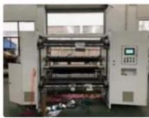
**Бобинорезательная машина 1300 мм автомат**
